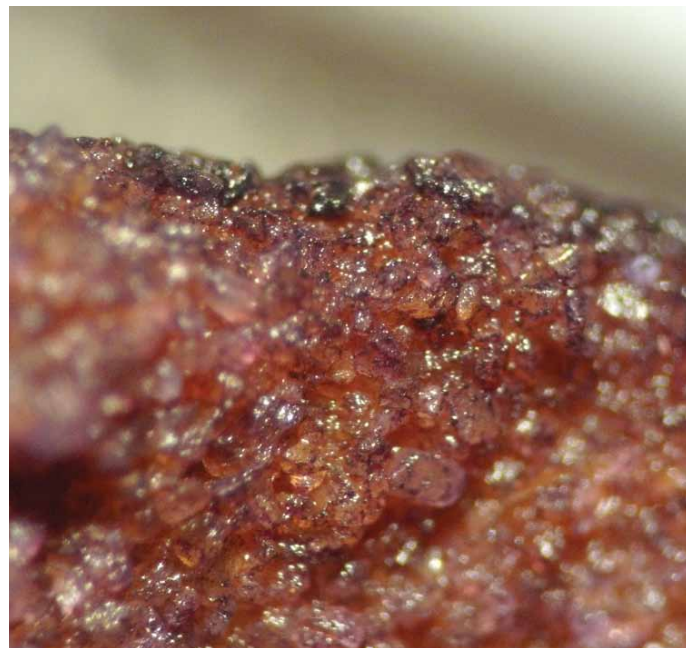
Obr. 1. Kolmatovaný pískovec ze zaplášťového prostoru vrtu, Drhлены. Biomasa a mezibuněčná hmota bakterií je obarvena toluidinovou modří (fialově)
